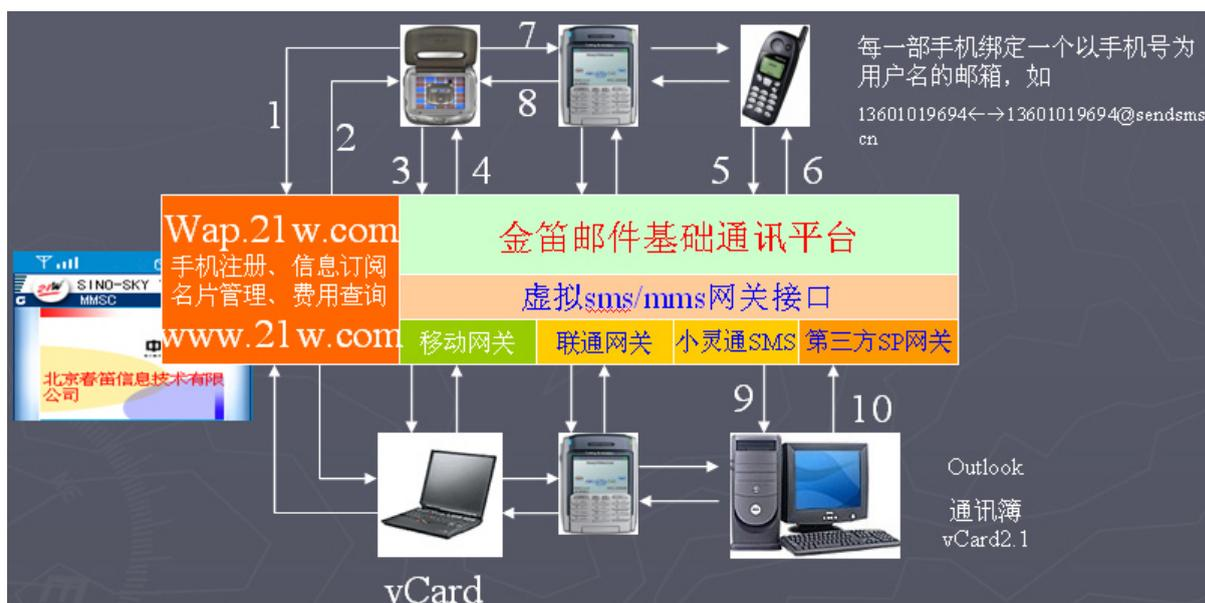
彩邮系统是以金笛集群邮件系统为基础通讯平台，在这个平台基础上，与中移动彩信、中国联通彩E业务融合，实现邮件与MMS统一存储、存储转发、互发互通。
